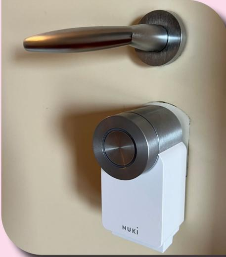
Robottino per serratura Nuki, non richiede la sostituzione del cilindro o interventi sulla porta blindata, viene montato all'interno con 2 viti o biadesivo e permette di comandare a distanza e automatizzare l'apertura della porta in massima sicurezza.
