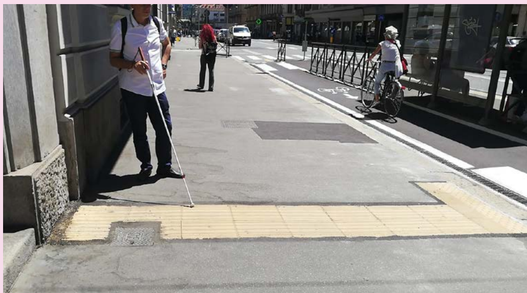
FOTO 4. L'ingresso ad una fermata bus dotata di segnalazioni LOGES rettilinee, di pericolo valicabile, di pericolo invalicabile e di guida naturale (transenna).
